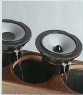
Der Tiefmitteltöner (rechts) trägt eine Phasennase.
